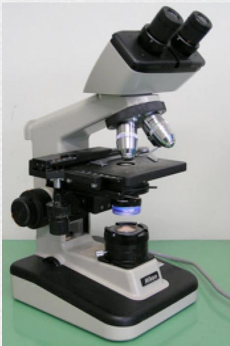
光学顕微鏡：可視光の透過、反射
