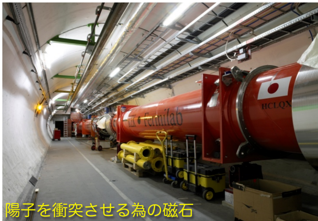
8.33テスラの超伝導磁石(1.9Kに冷却)
