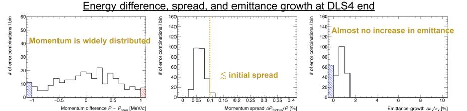
各加速管で位相誤差 $\pm 1$ 度、振幅誤差 $\pm 0.5\%$ 程度であれば要求品質を満たす\*
