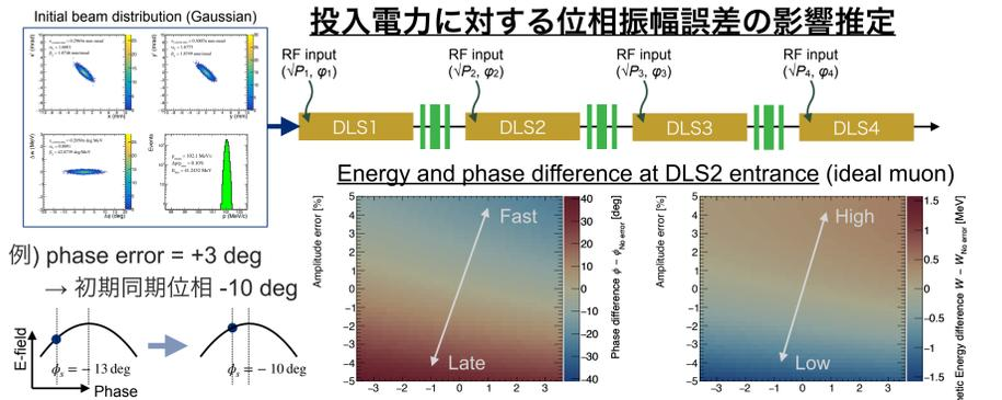
位相振幅誤差  $\Delta\phi_1, \Delta\sqrt{P_1}$  により加速中に大きな位相ずれが生じ、 $\phi_2$ の位相誤差に上乗せ
